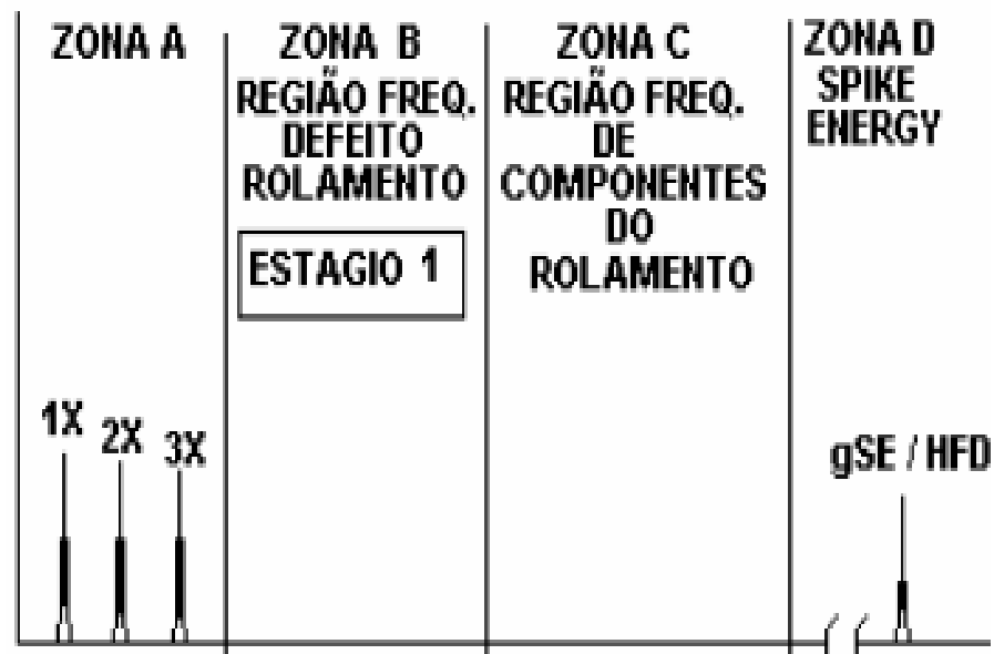
Figura 39: Espectro teórico do primeiro estágio na degradação de um mancal de rolamento.
