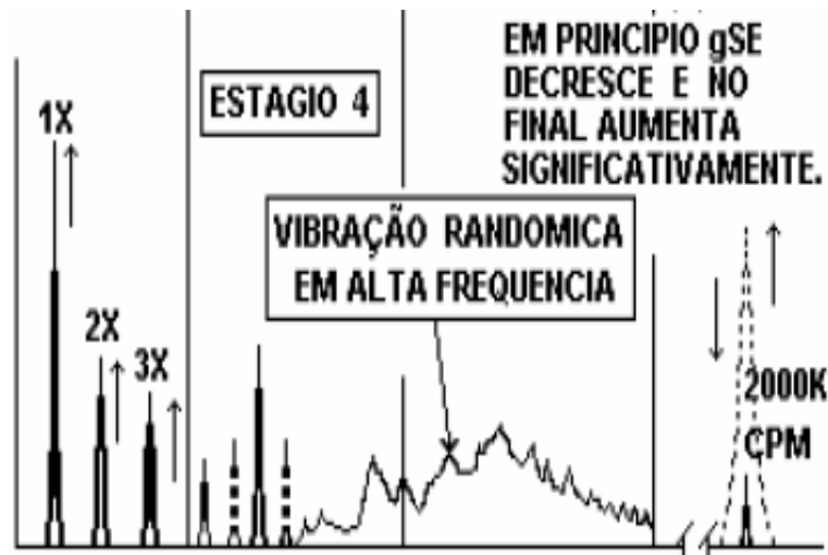
Figura 42: Espectro teórico do quanto estágio na degradação de um mancal de rolamento.
