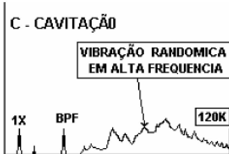
Figura 47: Espectro teórico de cavitação
