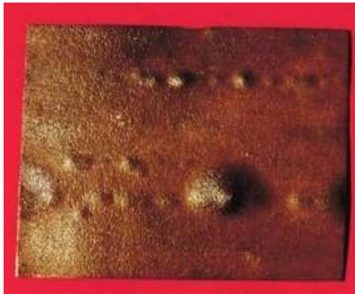
Figura 2 – chapa de aço-carbono com empolamento por hidrogênio ( http://engenheirodemateriais.com.br/wp-content/uploads/2017/04/ABAAAASVEAE-17.jpg )
