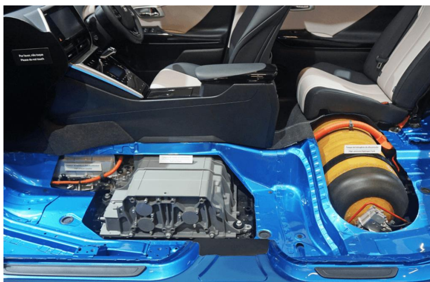
Figura 14 – Tanque de Hidrogênio localizado abaixo dos bancos do veículo ( https://carroeletrico.com.br/wp-content/uploads/2017/12/Mirai-interior-2-1024x665.png )
