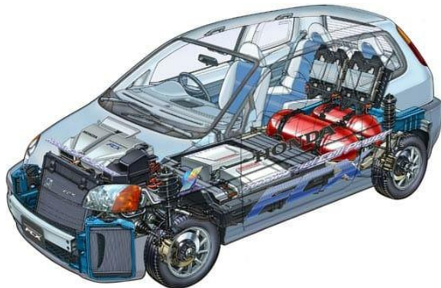
Figura 7 – Tanque de armazenamento de hidrogênio de um veículo da Honda ( http://revistapesquisa.fapesp.br/2006/08/01/reforma-energetica/ )
