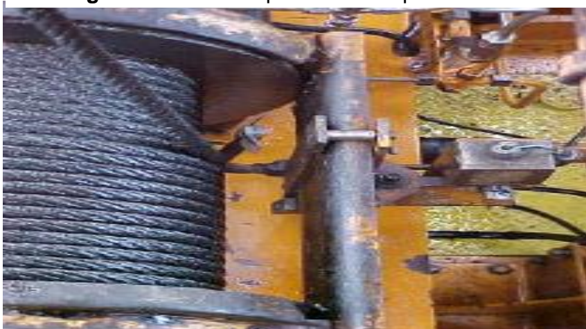
Figura 27. Limite superior atuado por alavanca.
