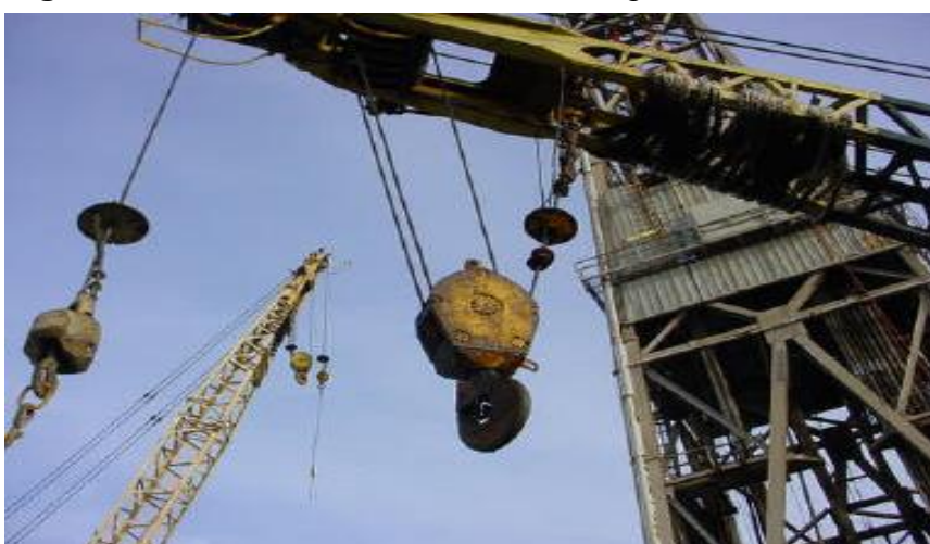
Figura 28. Anti-two block” instalado em guindastes offshore.
