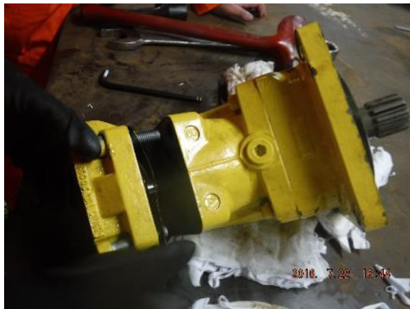
Figura 38. Remoção do bloco hidráulico e desmontagem do motor.
