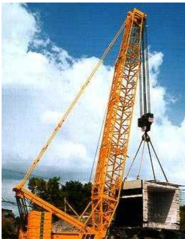
Figura 18. Içamento de carga (Momento de tombamento).
