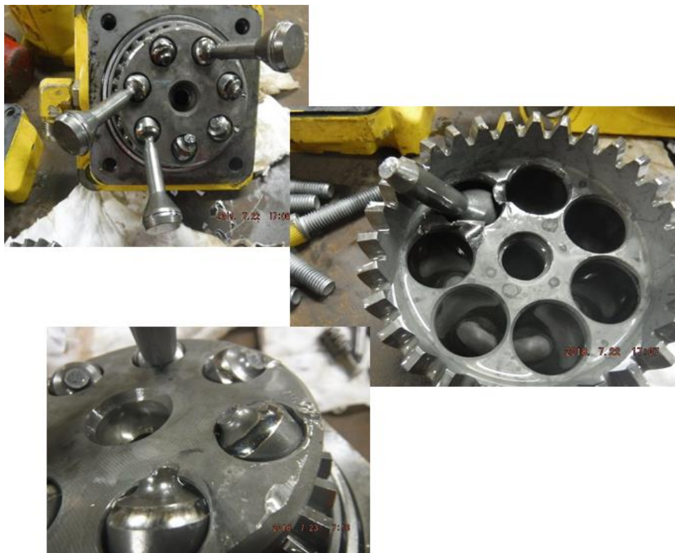
Figura 39. Identificação de quatro pistões quebrados.
