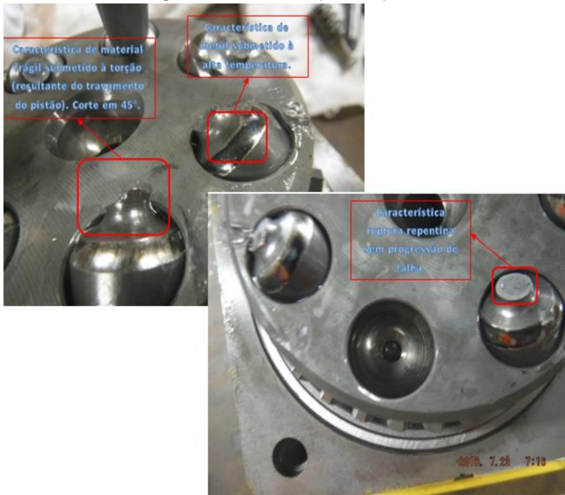
Figura 51. Análise da ruptura do pistão
