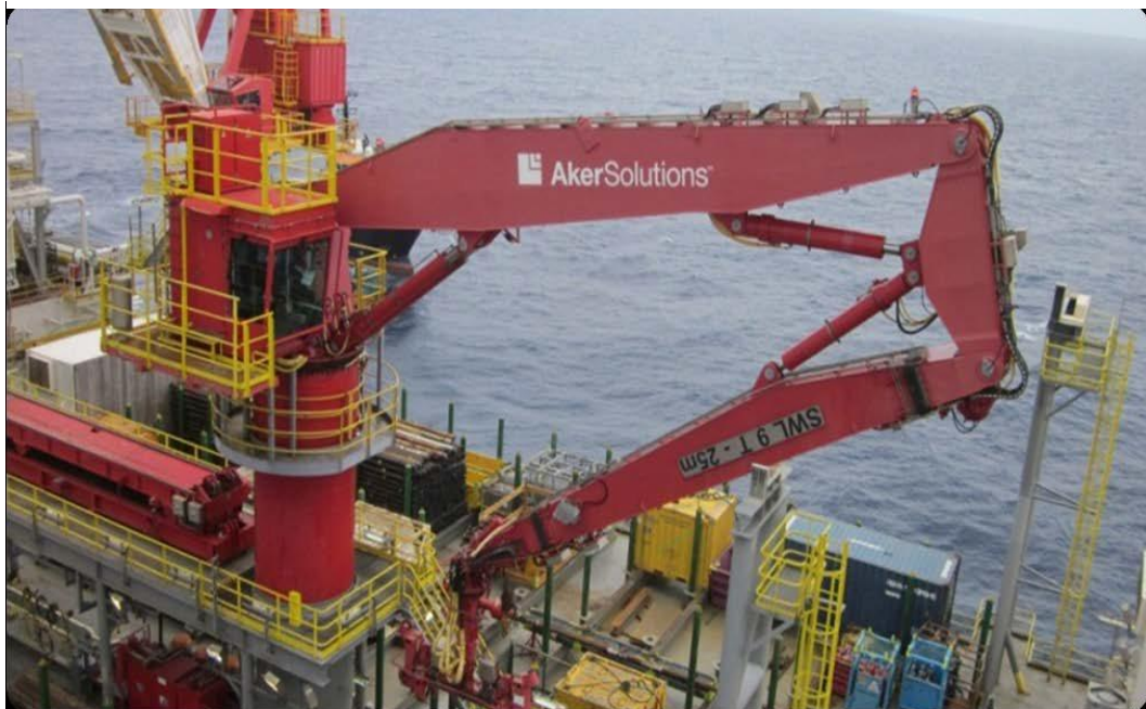
Figura 13. Guindaste com três seções de lança articulada.
