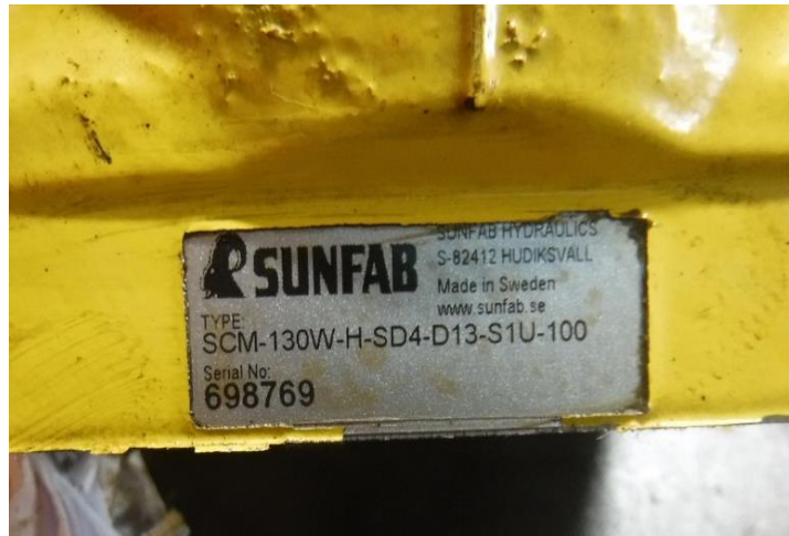
Figura 44. Informações técnicas do motor hidráulico Sunfab.
