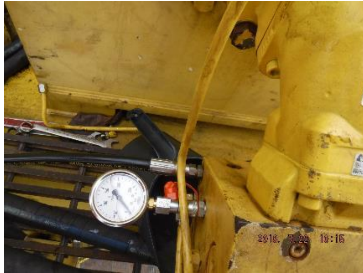
Figura 35. Manômetro inserido na linha piloto do freio
