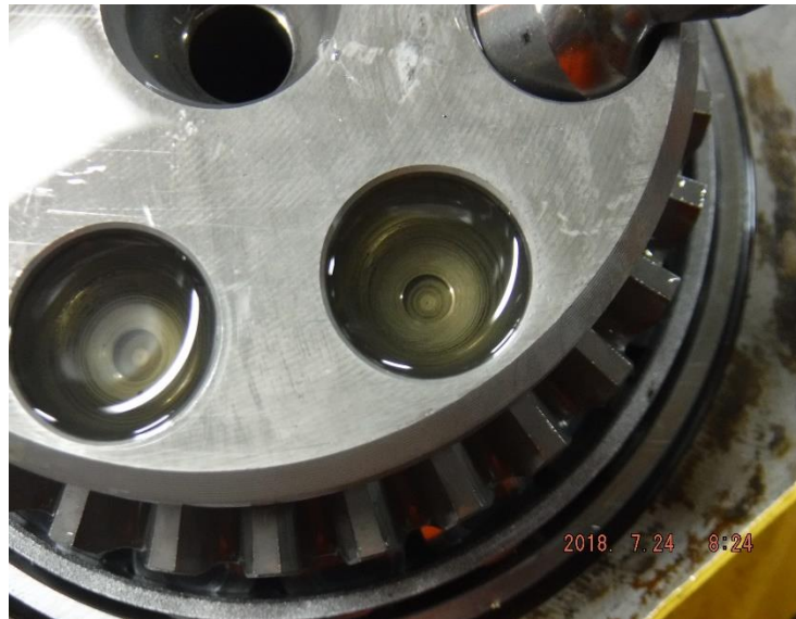
Figura 53. Camada de óleo no alojamento dos pistões
