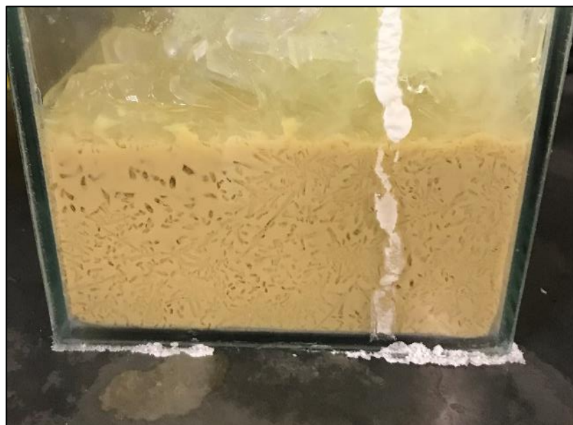
Figura 19 - Precipitado formado junto a cristais de soda cáustica (Fonte: Autor, 2018).
