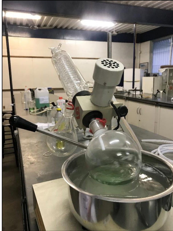
Figura 16 - Rotaevaporador com glicerina aquecida (Fonte: Autor, 2018).
