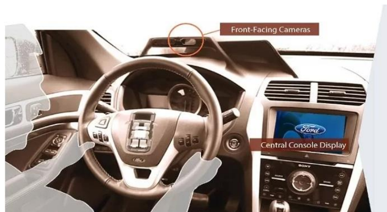
Figura 2: Project Mobii prevê instalação de diversas de câmeras e sensores dentro dos carros
