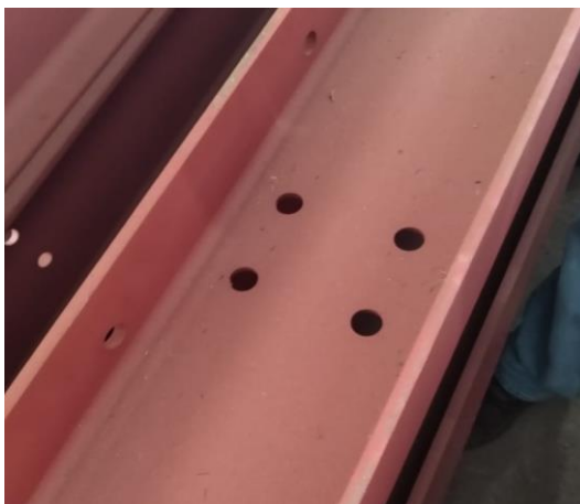
Figura 26 - Furação com o maçarico. Fonte: Autores (2019).
