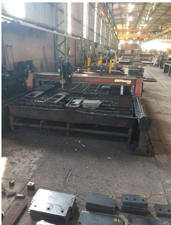
Figura 21 - Máquina de corte plasma - UNIPlasma. Fonte: Autores (2019).
