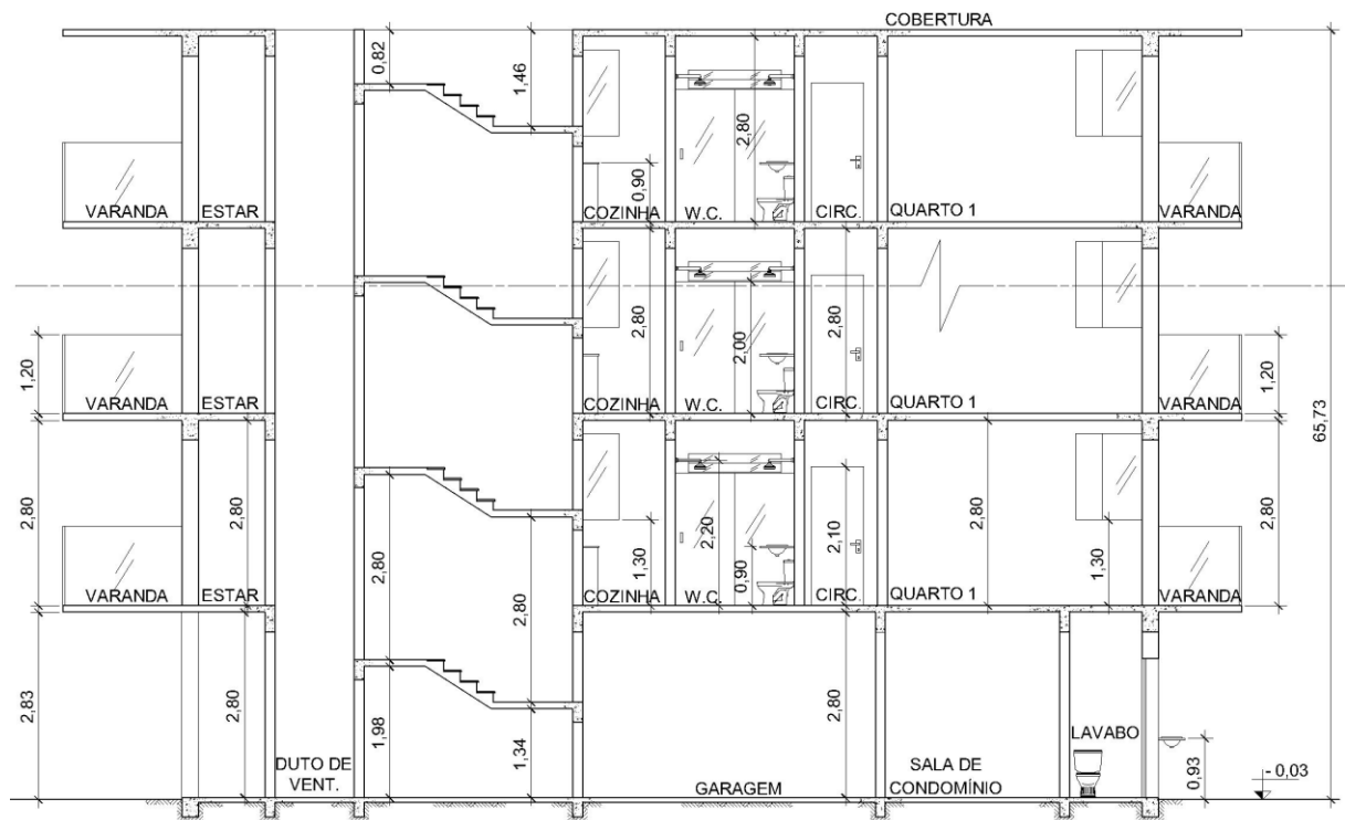
Figura 22 –Corte A-A do edifício teórico
