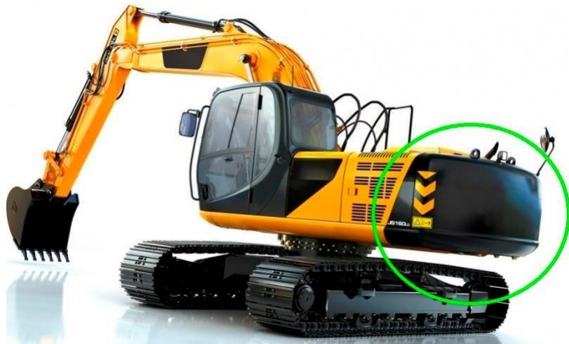
Figura 9: Contrapeso da escavadeira em destaque
