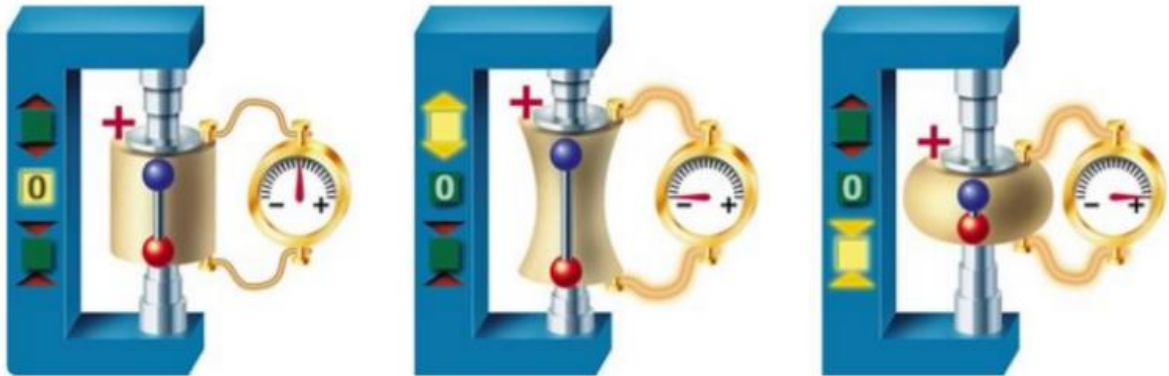
Figura 10: Efeito piezoelétrico de modo direto. Fonte: Ceramtec, 2017
