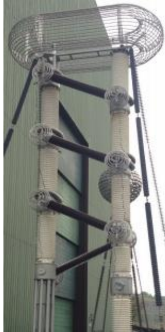
Figura 28: Retificador de tensão nominal de 1MV do tipo Cockcroft – Walton.
