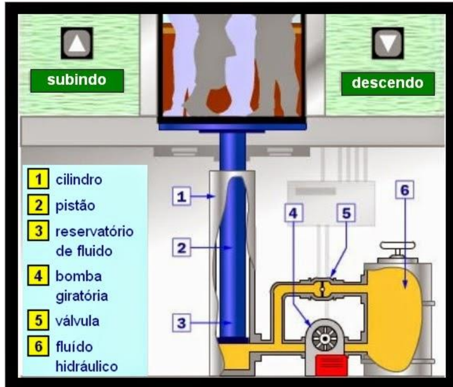
Figura 41 - Funcionamento do elevador hidráulico. Fonte: Bombeiro Oswaldo Blog Spot.
