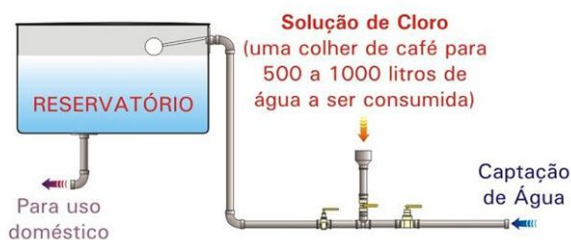
Figura 11: Instalação do clorador de água desenvolvido pela Embrapa com destaque para seus componentes.
