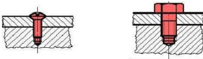
Figura 16. Parafusos não passantes.
