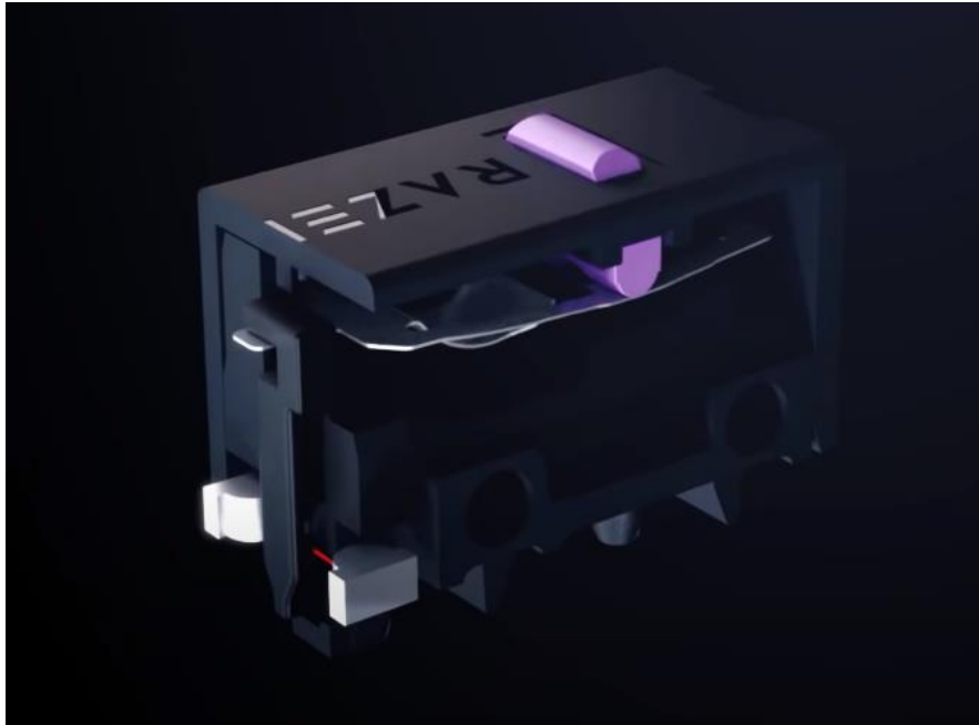
Figura 10 – Render 3D do funcionamento do botão óptico Fonte: Razer (2020)
