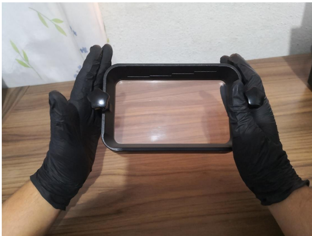
Figura 122 – Tanque de resina Fonte: Acervo dos Autores
