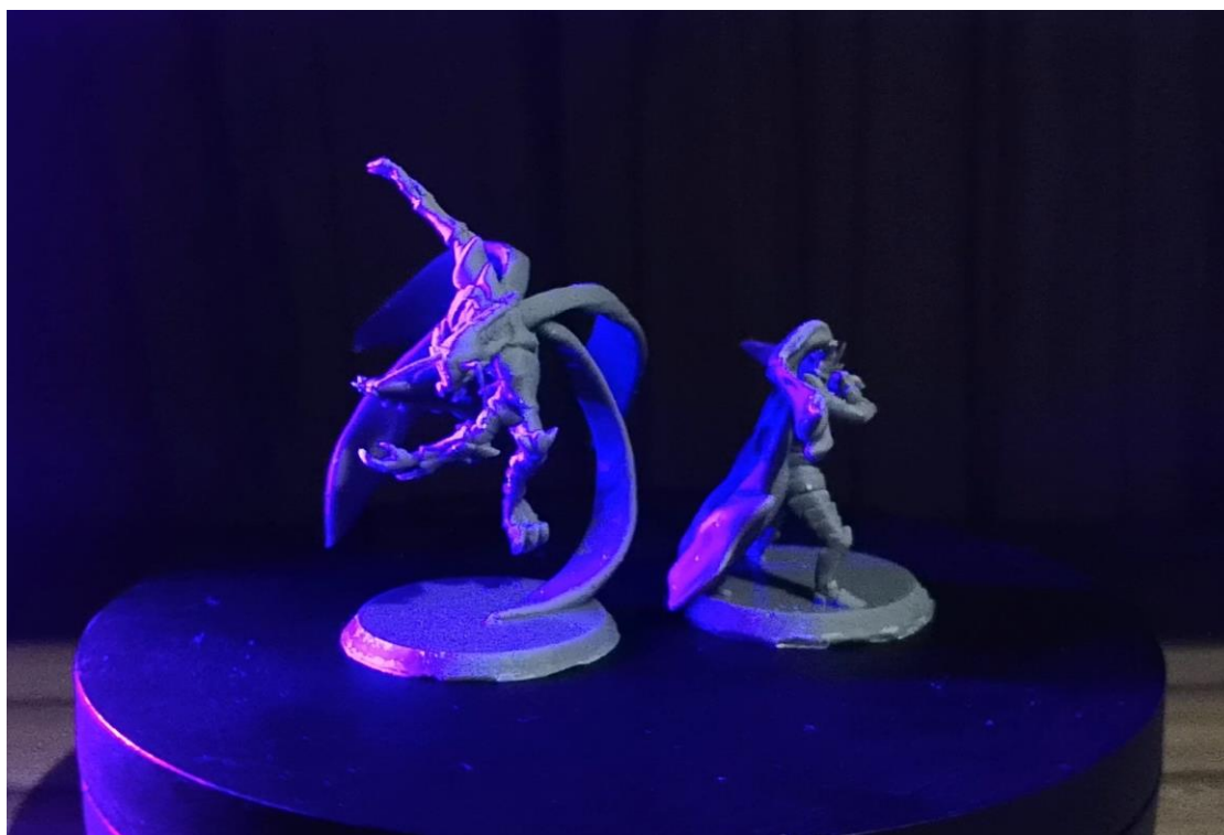
Figura 129 – Peças sendo curadas na luz UV Fonte: Acervo dos Autores
