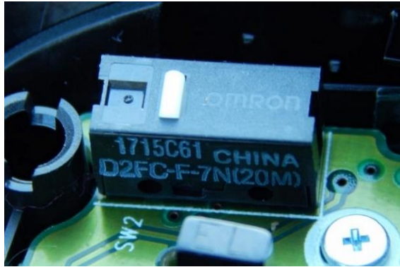
Figura 34 – Switch OMRON D2FC Fonte: Oficina da Net – Diesel (2016)
