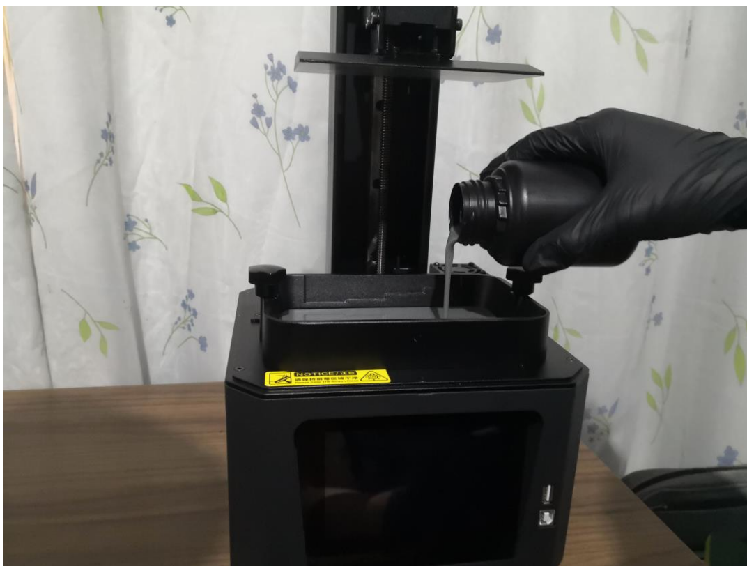
Figura 124 – Resina sendo depositada no tanque Fonte: Acervo dos Autores
