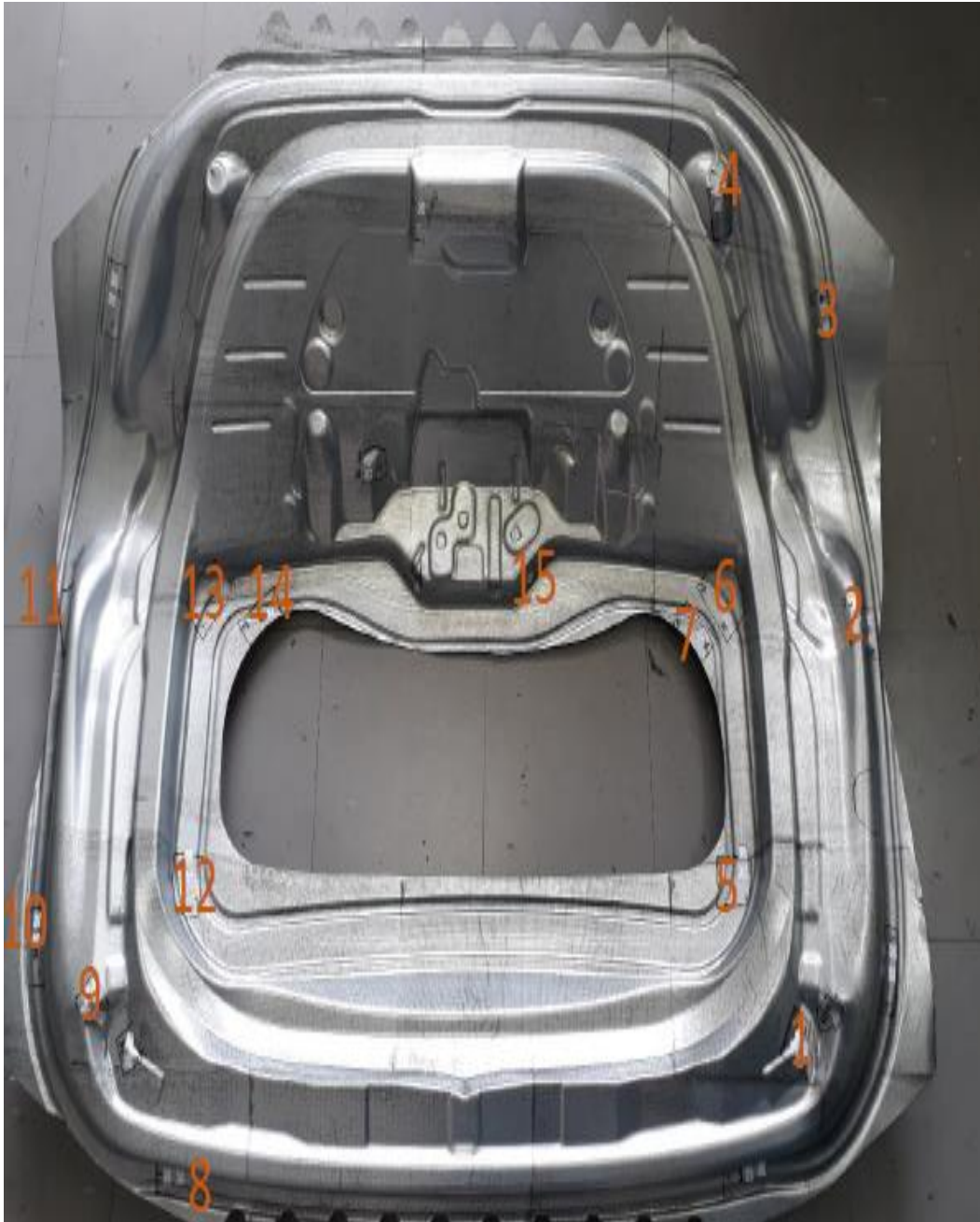
Figura 19 – fotografia de uma peça automotiva após estampagem com a identificação de cada região a ser estudada – Indústria automobilística
