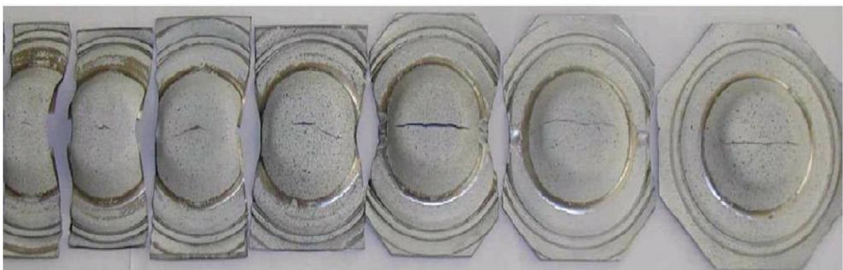
Figura 8 – Corpos de prova após ensaios segundo metodologia Marciniak de uma chapa de aço. As larguras dos corpos de prova variam entre 60 a 200 mm. (Makkouket al. 2008).
