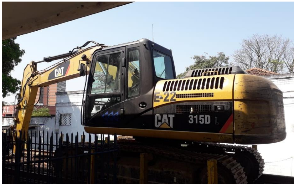
Figura 37: Escavadeira CAT 315-D.
