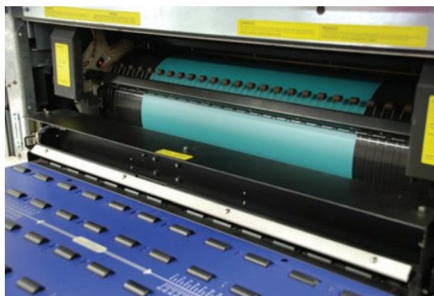
Figura 9: Gravadora de chapas offset – Chapa para impressão offset no interior de uma máquina do sistema computer-to-plate , antes do processamento
