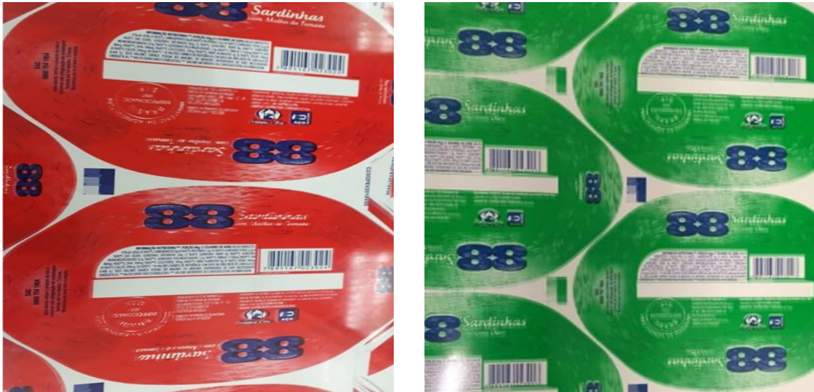
Figura 14: Refugo folha com barba após impressão offset
