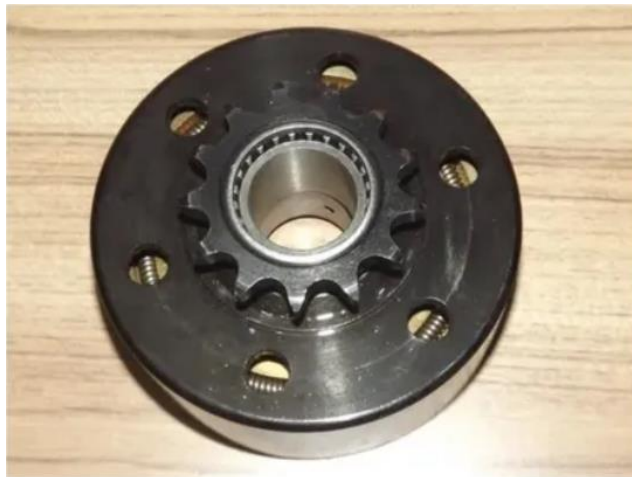
Figura 26 - Embreagem centrífuga em aço com 13 dentes
