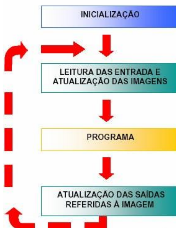
Figura 2 – Ciclo de Varredura do CLP
