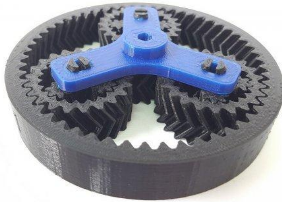
Figura 27 - Conjunto de Engrenagens Impressos
