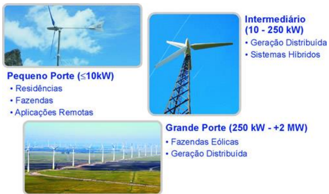
Figura 52 - Considerações sobre o tamanho dos aerogeradores e suas principais aplicações – Fonte: CRESESB, 2005.
