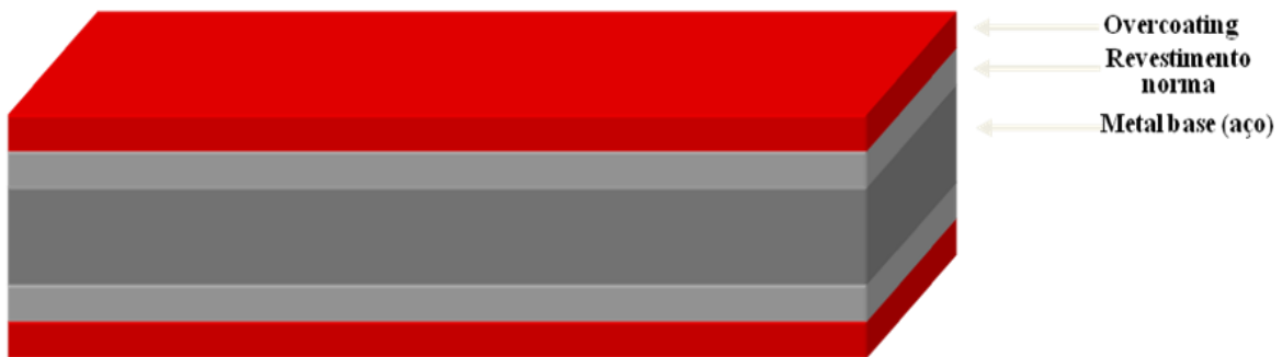
Figura 51 - Representação do overcoating em uma chapa de aço zincada.
