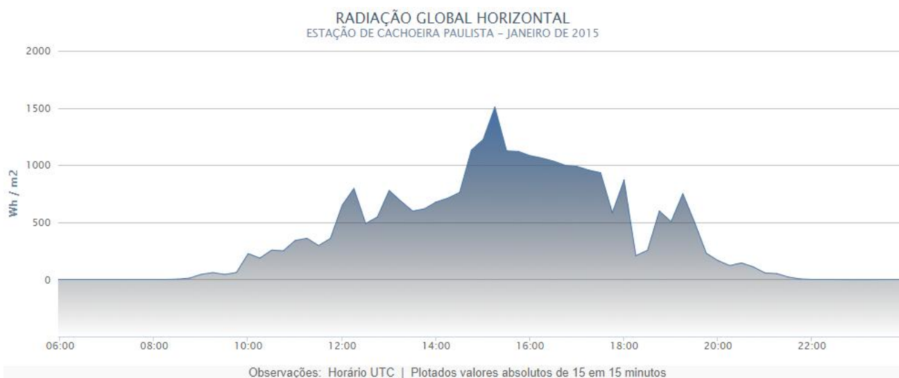
Figura 5.11 – Radiação global horizontal para a cidade de Cachoeira Paulista para o dia 28 de janeiro de 2015.
