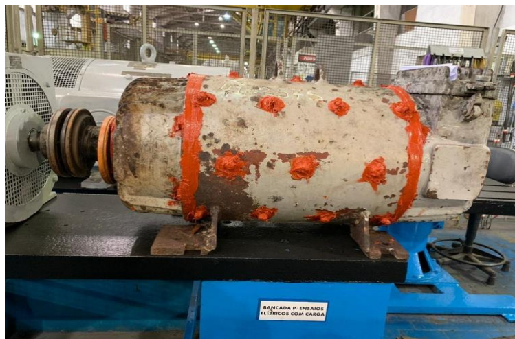
Figura 1 – Motor de Imã Permanente em Ensaio com Carga
