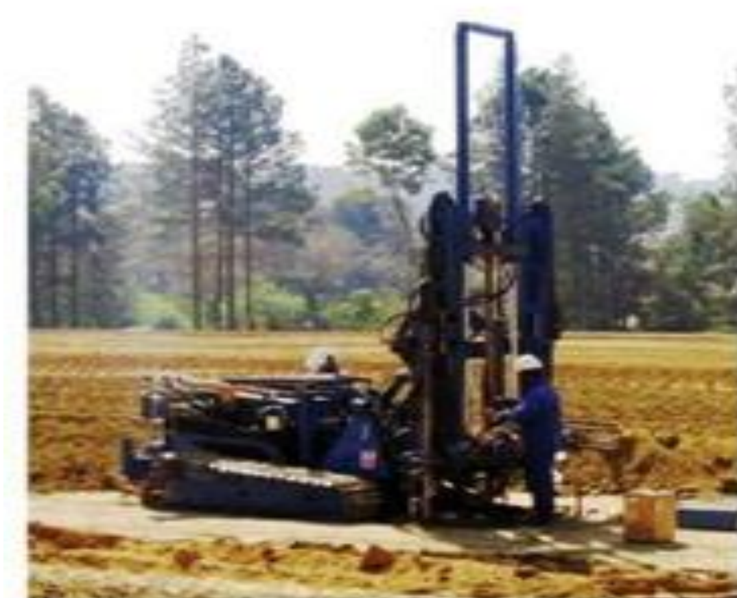
Figura 15 - Sistema pesado sobre esteiras 200 KN.
