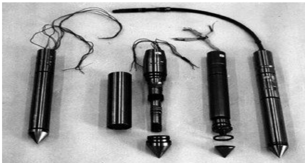
Figuras 16 - Principais componentes Cone e Piezocone Fonte: SCHNAID E ODEBRECHT, (2012).
