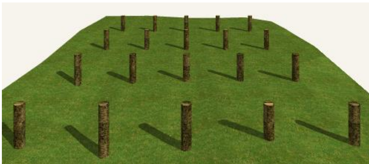
Figura 8 – Estacas cravadas de madeira.
