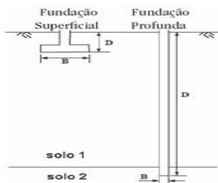
Figura 1 – Tipos de Fundações. Fonte: http://construironline.dashofer.pt
