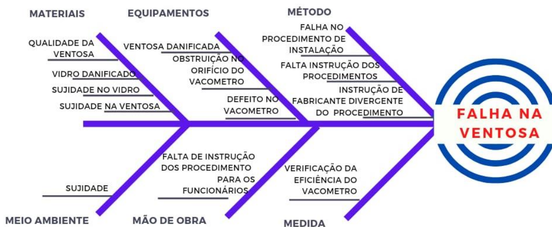
Figura 12: Diagrama de causa e efeito da falha da ventosa
