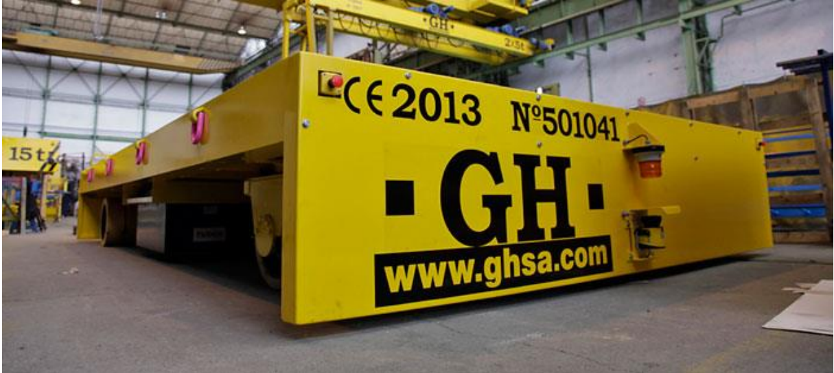
Figura 4: Carro de transferência direcional a bateria (Fonte: GH Cranes & Components)
