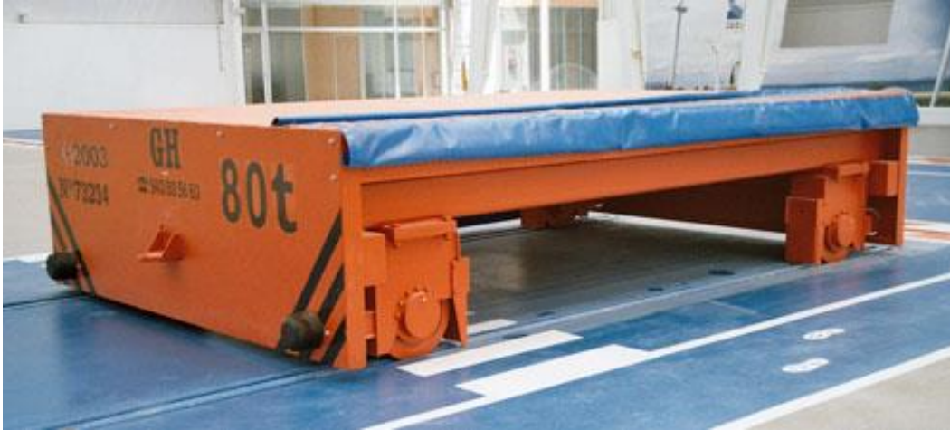
Figura 6: Carro de transferência elétricos sobre trilhos (Fonte: GH Cranes & Components)
