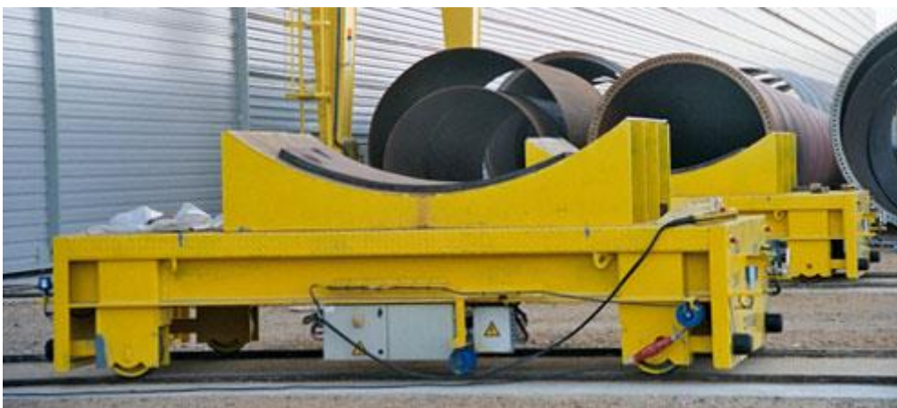
Figura 5: Carro de transferência sobre trilhos a bateria (Fonte: GH Cranes & Components)
