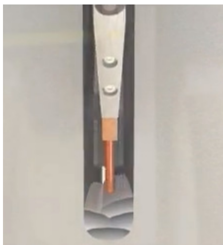
Figura 11: Esquema da soldagem TIG com chanfro estreito
