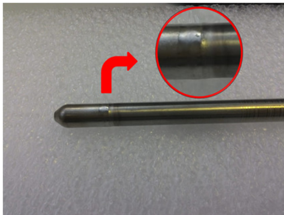
Figura 38: Cordão de solda com inclusão de tungstênio Fonte: Desenvolvido pelos autores (2018)
