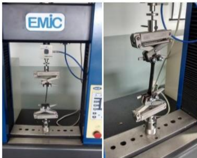
Figura 14: Máquina EMIC DL 5000/10000 utilizada no ensaio de tração.
