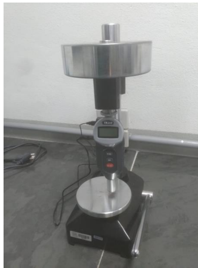
Figura 17: Durômetro Portátil Digital – Shore D (STM D 2240-02).
