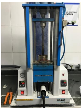
Figura 13: Máquina injetora RAY RAM, modelo TSMP.
