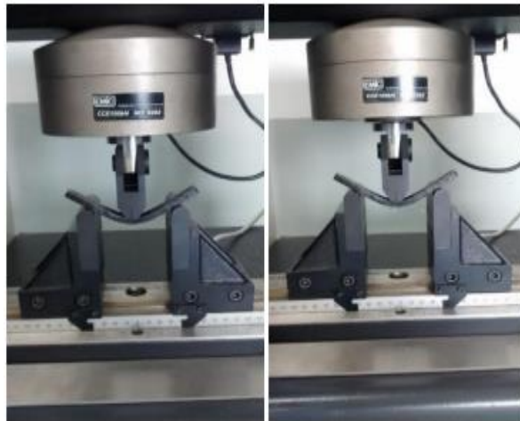
Figura 15: Máquina EMIC DL 5000/10000 utilizada no ensaio de flexão.
