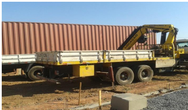
Figura 11: Posicionamento do caminhão munck ao lado do terreno
