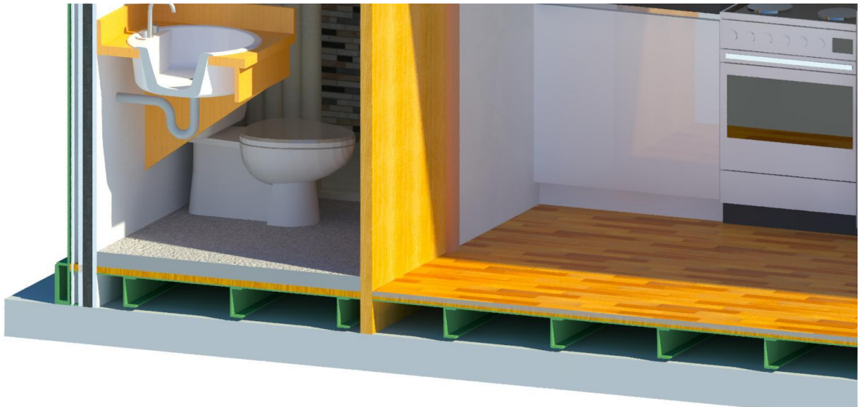
Figura 18: Piso laminado de madeira e piso cerâmico
