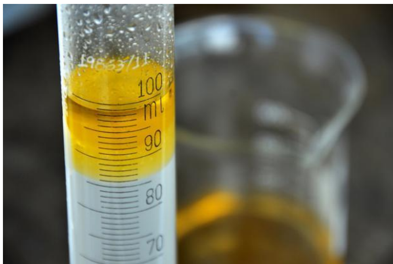
Figura 7 - Proveta medindo o teor de etanol anidro à gasolina. Fonte: BRASILPOSTOS (2016).
