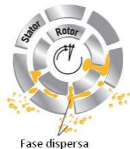
Figura 8 – Rotor estator de uma bomba agitadora. Fonte: ALMEIDA (2014).
