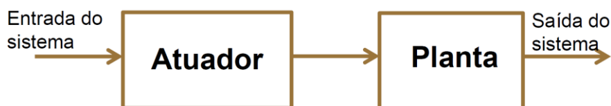
Figura 19 – Diagrama de Bloco de Controle de Malha Aberta. Fonte: BOJORGE (2013).
