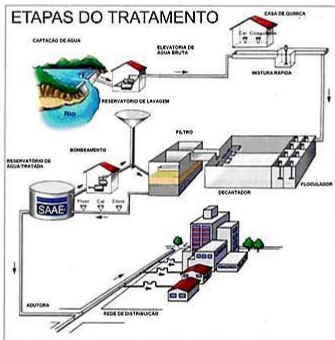
Figura 3 - Etapas do Sistema de Abastecimento de Água
