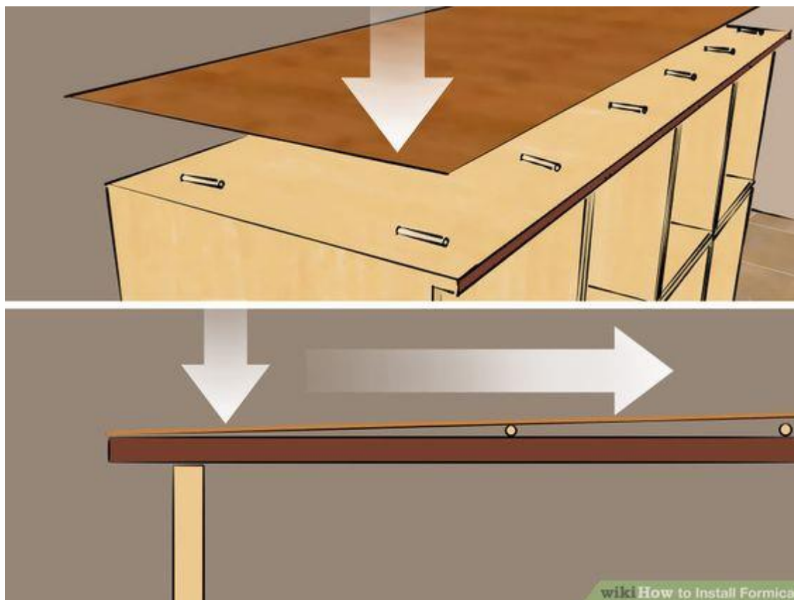
Figura 25: instalação da fórmica
