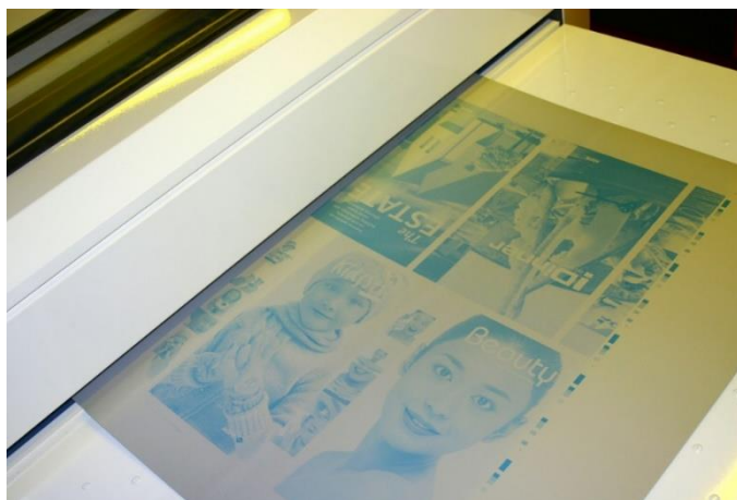
Figura 53 - Chapa de impressão offset
