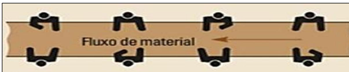
Figura 2 - Exemplo Layout Por Produto (Em Linha)
