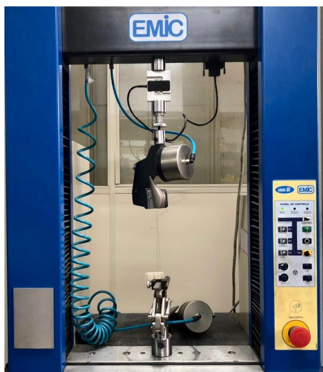
FIGURA 3 - Máquina universal para ensaios mecânicos - EMIC com amostra posicionada e dispositivo para ensaio mecânico de cisalhamento
