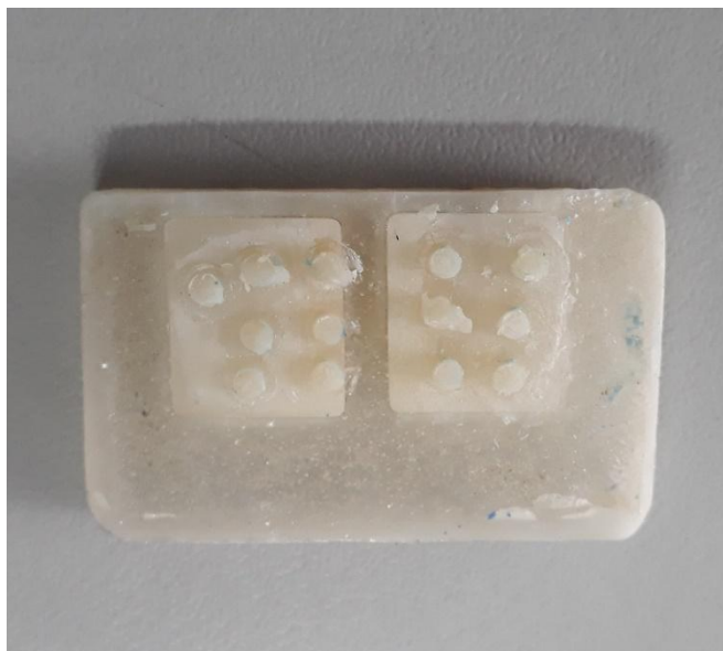
FIGURA 2 – Amostra composta dos blocos experimentais de cerâmica híbrida com cilindros de cimento resinoso cimentados
