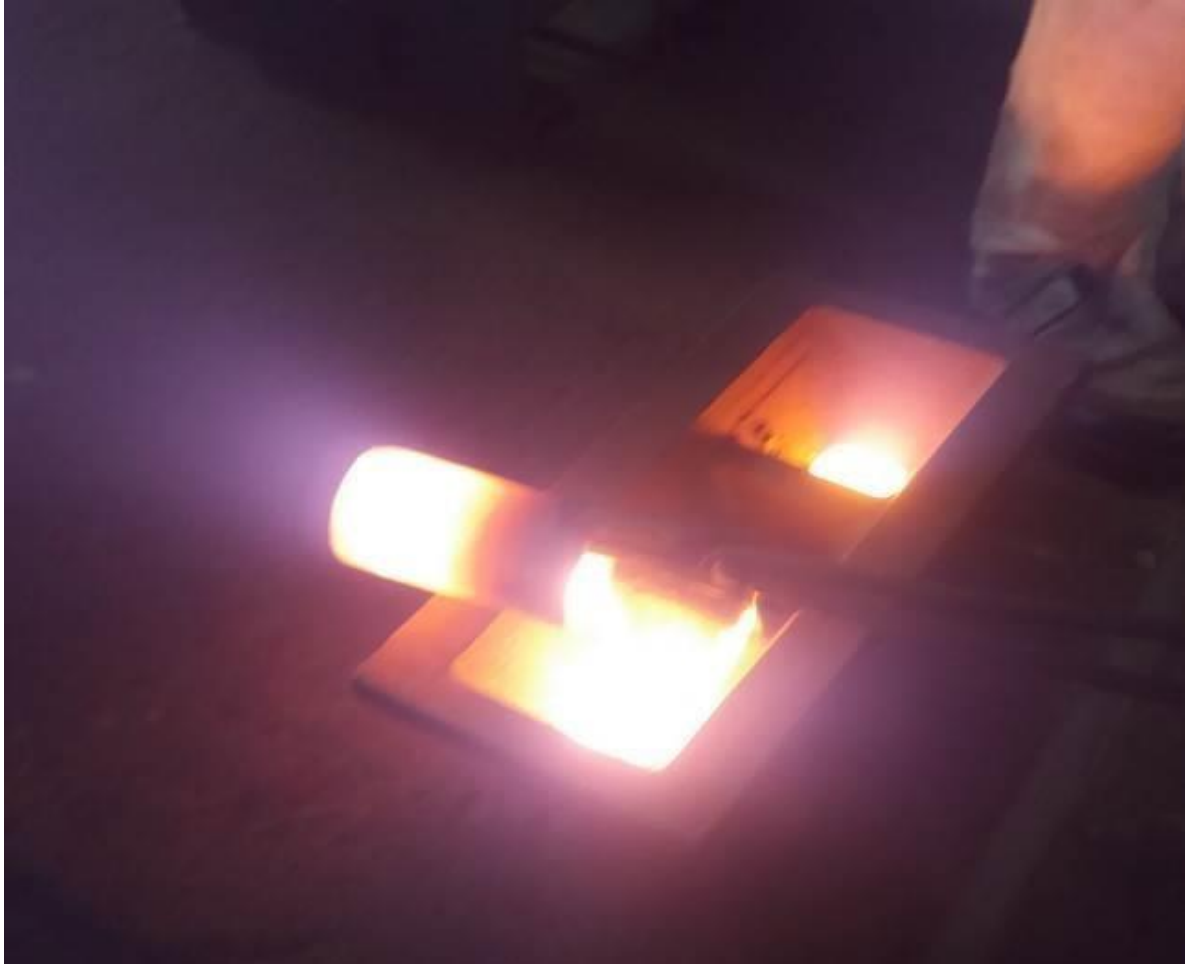
Figura 19: Vazamento do ferro gusa líquido no molde.
