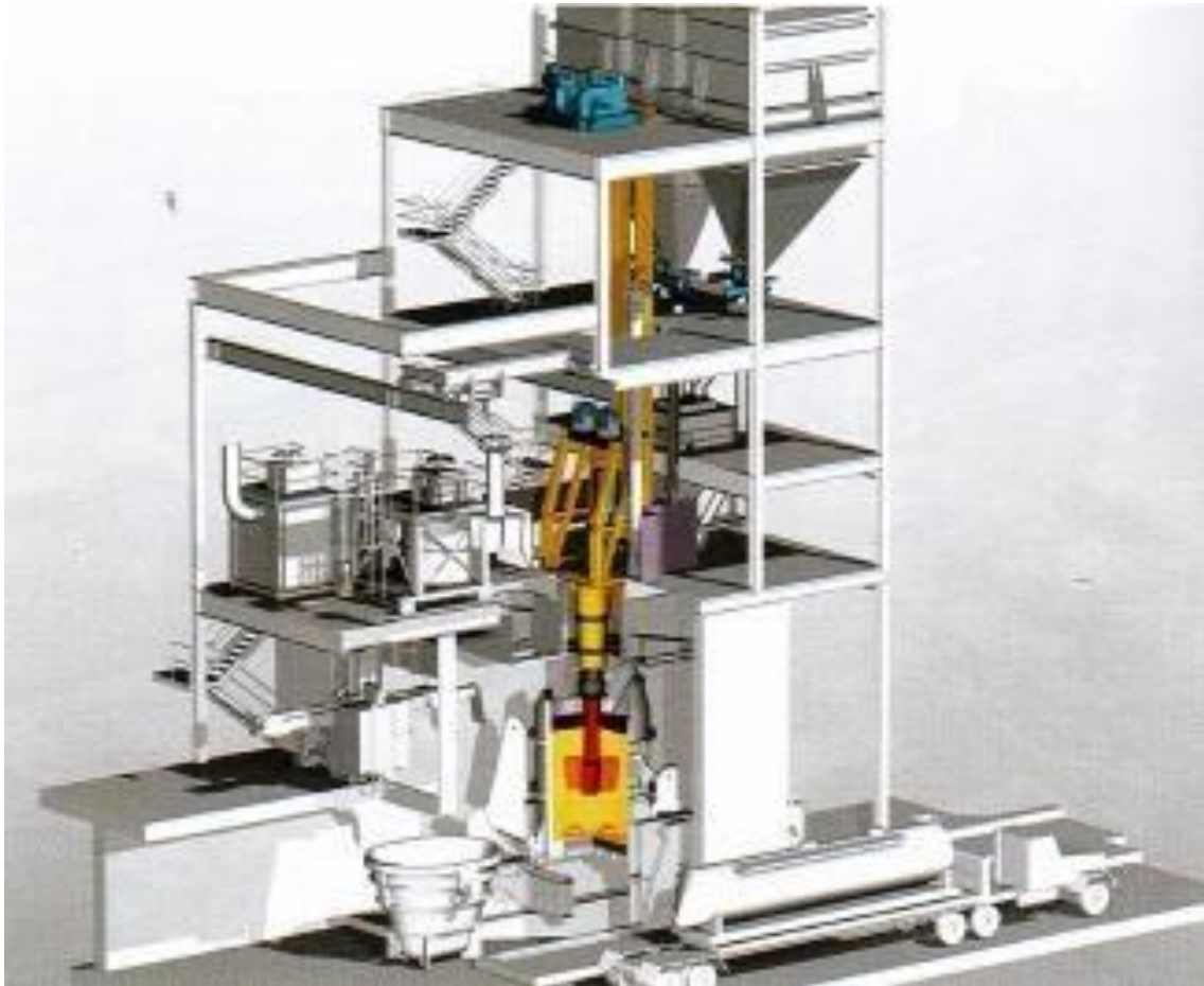
Figura 8: Esquema em 3D da nova tecnologia Simetal HM KR Dessul
