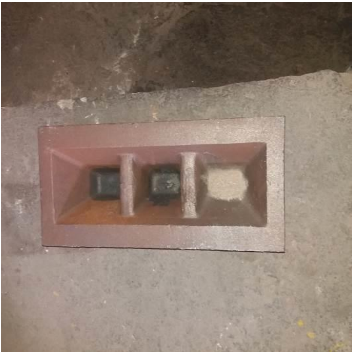
Figura 18: Molde preparado com carbureto de cálcio para vazamento do metal líquido.
