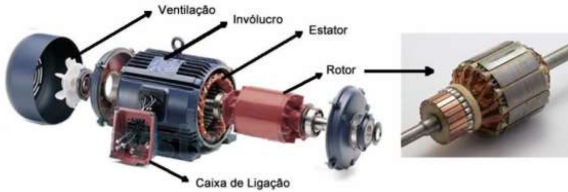
Figura 22 – Componentes de um motor Fonte: Citisystems (2020)
