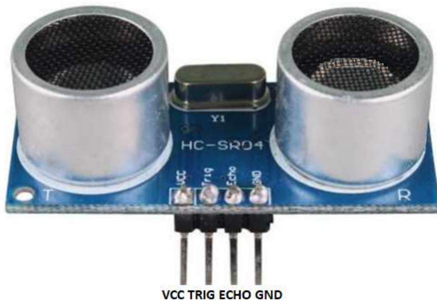
Figura 15 – Pinos de Conexão Sensor Ultrassônico HC-SR04 Fonte: https://create.arduino.cc/ (2020)
