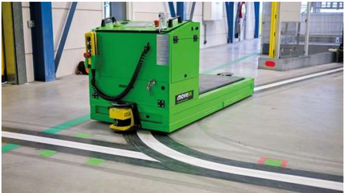
Figura 2 – AGV Guiado por Fita Magnética Fonte: https://www.turck.us/ (2020)
