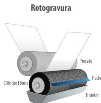
Figura 47: Processo de rotogravura
