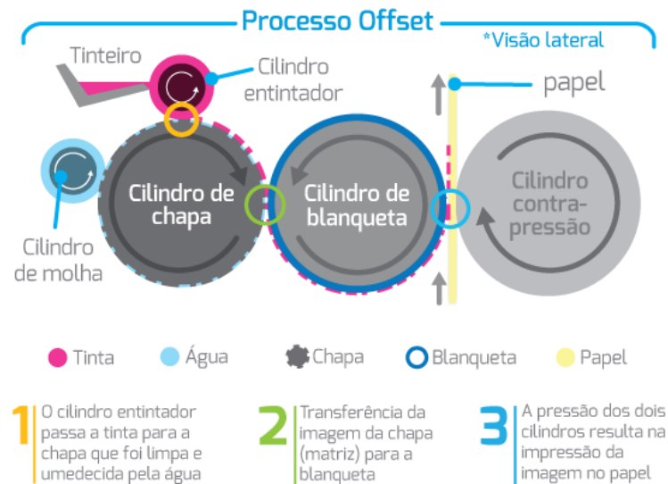
Figura 46: Processo de Offset
