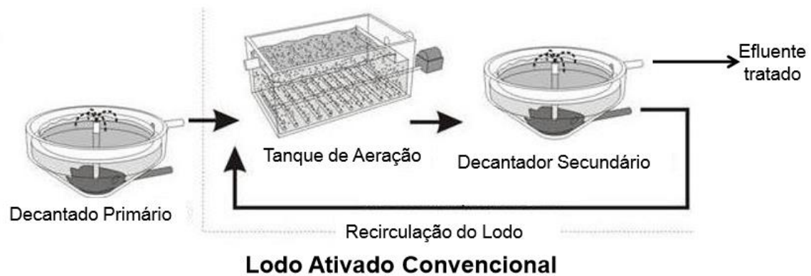
Figura 6: Esquemas das unidades da etapa dos lodos ativados.
