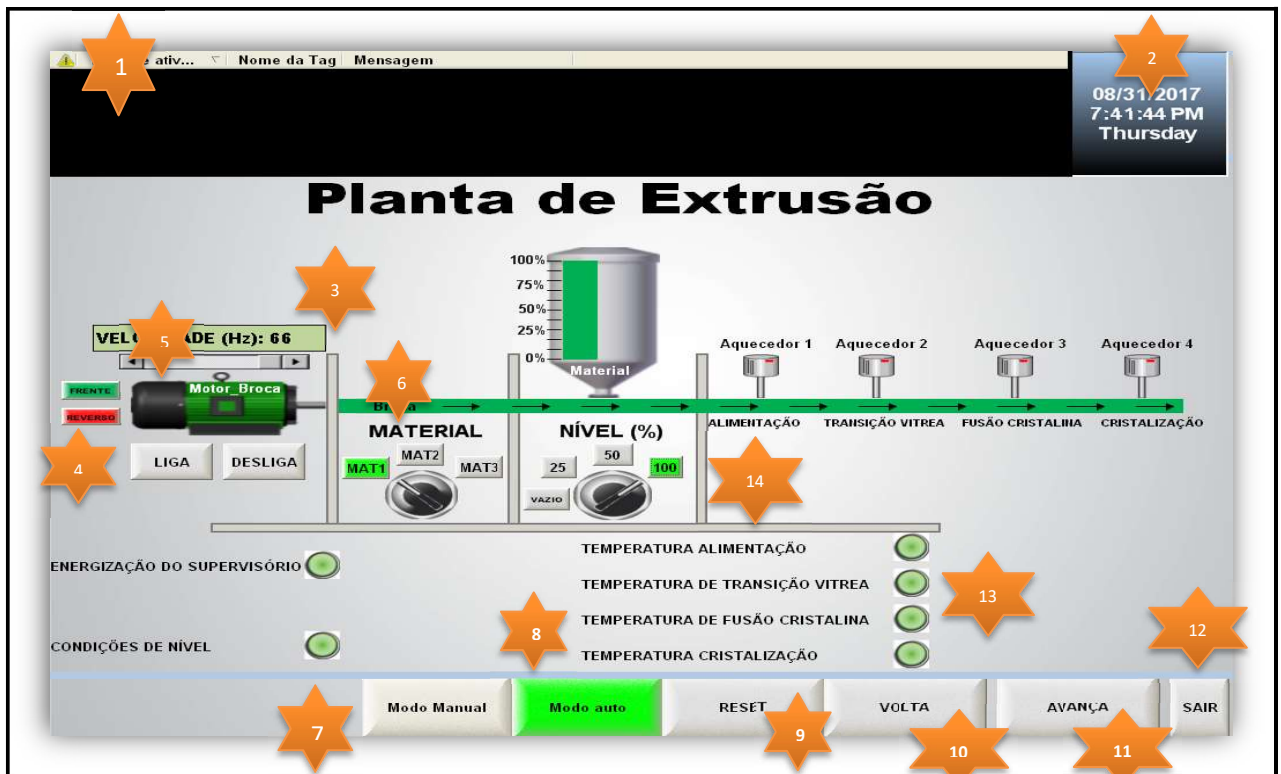
Figura 38: Tela da Planta de Extrusão.
