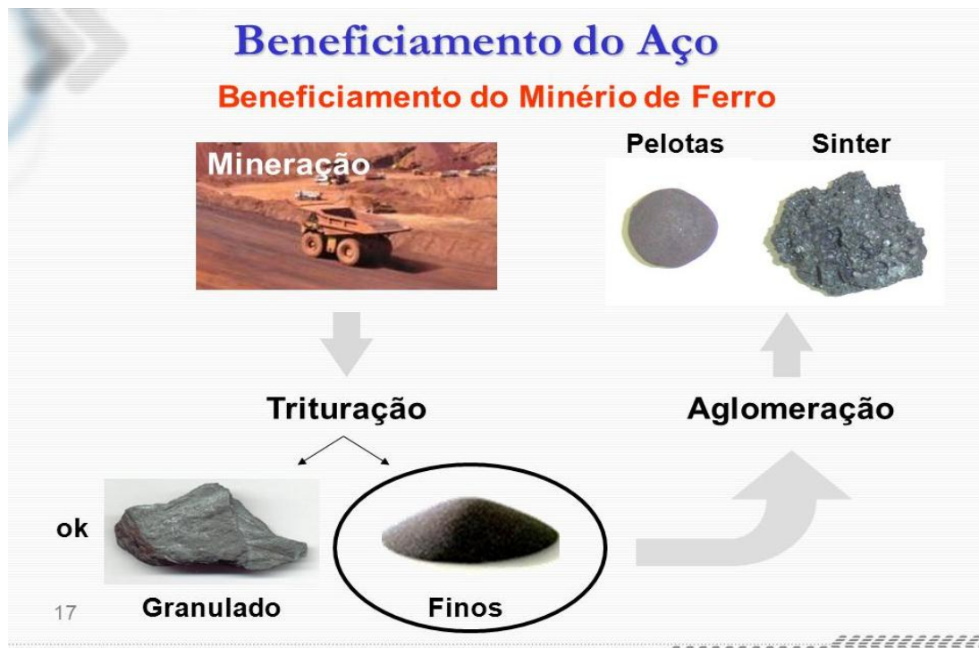
Figura 5 - Ilustração do processo de beneficiamento do minério de ferro (Fonte: adaptado de slideplayer.com.br)
