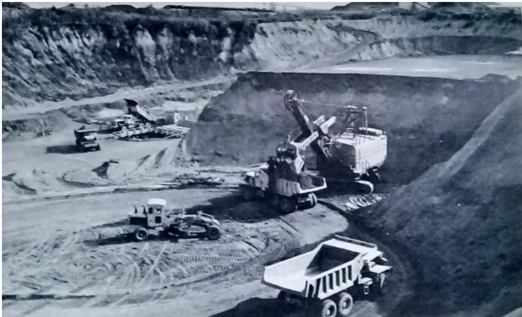
Figura 3 - Pá de energia elétrica manipulando minério bruto de concentração (Fonte: USS - United States Steel)
