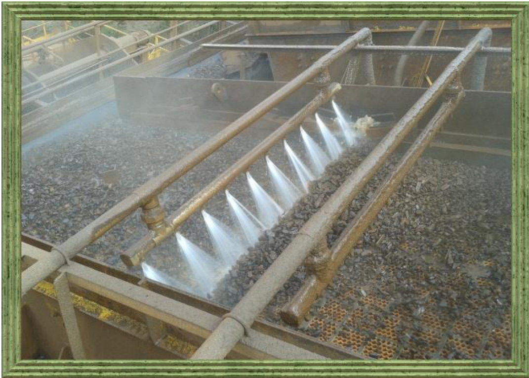
Figura 6 - Sistema de lavagem de minério em uma peneira vibratória (Fonte: adaptado de www.fluidjet.com.br )
