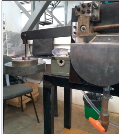
Figura 20 - Detalhe do peso morto no braço de alavanca do dispositivo de desgaste em escala reduzida.
