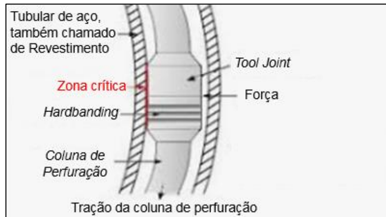
Figura 4 - Contato do tool joint com a parede interna de um revestimento.
