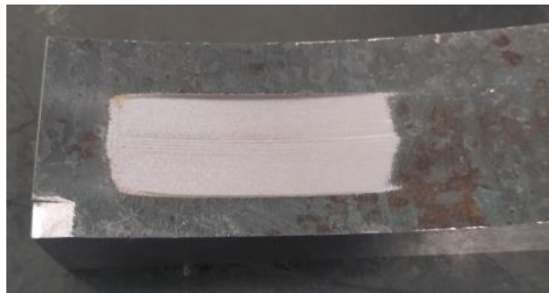
Figura 22 - Detalhe da superfície interna desgastada da amostra do tubo API 5CT C-110.
