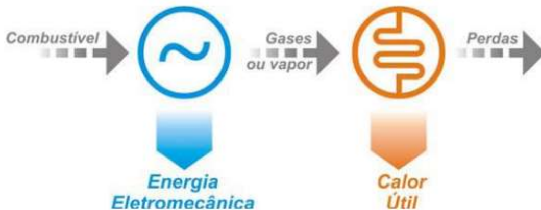
Figura 10: Ciclo a montante ( Topping )
