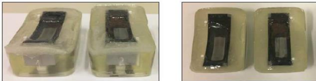
Amostras embutidas com resina epoxy Aka
