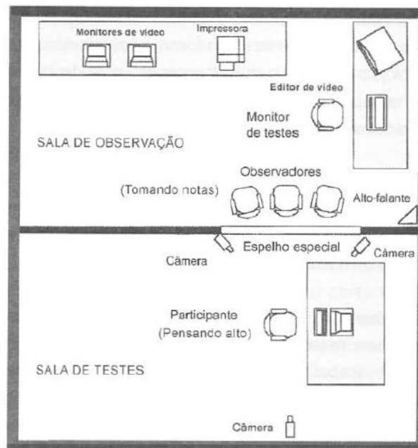
Figura 52 – Planta de laboratório para testes de usabilidade
