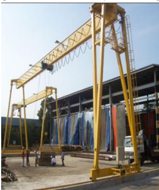
Figura 4. Ponte Rolante Apoiada Univiga
