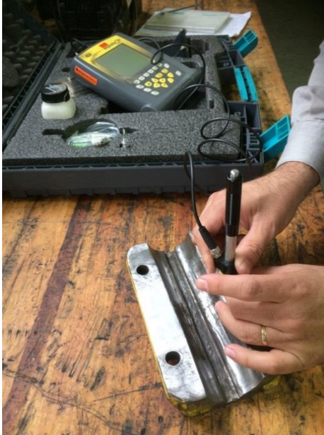
Figura 17 - Registro durante a realização do ensaio de Dureza do Acoplamento .
