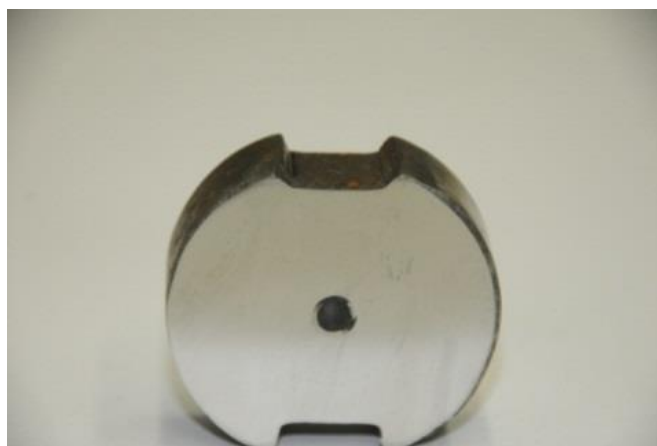
Figura 14- Amostras do eixo com desgaste em um dos lados.
