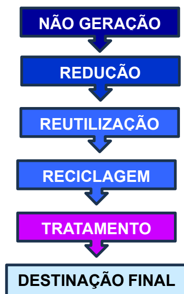
Figura 1: Ordem de prioridade na gestão de resíduos conforme determinado pelo artigo 9º da PNRS
