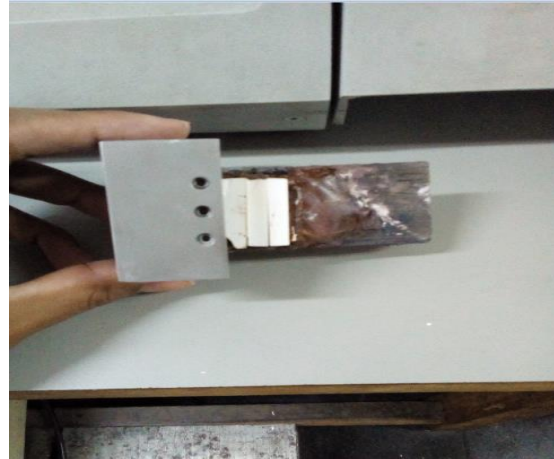
Figura 3: Bloco cerâmico fixado ao suporte.
